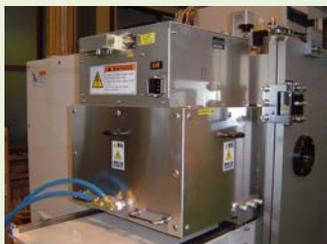
RF 電極でフィルムの表面をプラズマ処理します。
